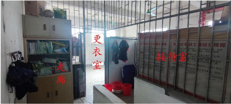
拆除现有金属防盗网、原有隔板和走廊上方架设板等，采用新隔板（到顶，含门）将二楼原仓库场地分隔成教师休息室（含接待室）（如下图所示）
